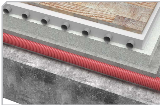
Заливка підлогового плена стяжкою підлоги (в комбінації з системою «тепла підлога»)
