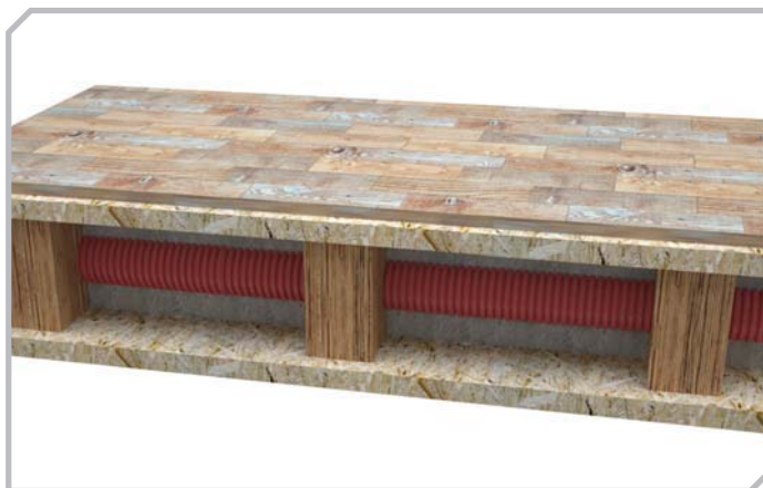
Всередині дерев'яного перекриття через балки
