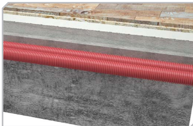
Заливка каналів у стяжку підлоги
