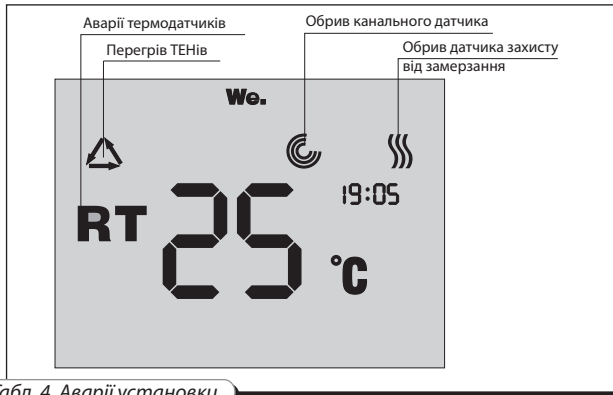
Табл. 4. Аварії установки
