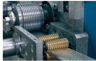
Цех виготовлення гнучких повітропроводів
