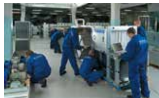
Цех виготовлення припливно-втяжних агрегатів AirVENTS
