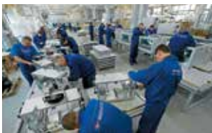
Цех виготовлення припливно-втяжних установок
