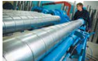
Виробництво спірально-навівних повітропроводів
